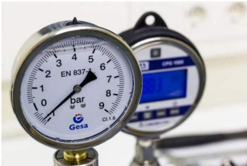
En général, le processus de d'étalonnage ce fait par, la comparaison d'une valeur inconnue et une connue et l'enregistrement des données obtenues.
