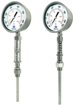
Thermomètres de dilatation de gaz fabriqué selon la norme **EN 13190**. Instrument fiable pour des conditions extrêmes de travail comme les vibrations de moteurs, l'humidité ou les milieux agressifs comme l'eau de mer. Spécialement conçus pour mesurer la température des gaz d'échappement des moteurs. Le boîtier du pyromètre est rempli avec huile de silicone pour amortir les vibrations.
